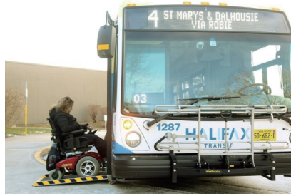
<그림 10> 캐나다 자동 경사 시스템 저상버스 (출처: CBC)
